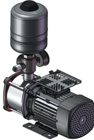
Установите монтажную пластину на клеммную коробку двигателя насоса, установите ее в соответствующее положение так, чтобы два длинных язычка были обращены вперед, и зафиксируйте винтами
